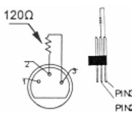
Een DMX eindweerstand is aanbevolen als de DMX-kabel vrij lang is of wordt gebruikt in een omgeving met veel elektrische ruis (bv. een discotheek). De eindweerstand voorkomt corruptie van het digitale controlesignaal door elektrische ruis. De DMX eindweerstand is niets meer dan een XLR-stekker met een weerstand van  $120\Omega$  van pin 2 naar 3. Deze XLR-stekker wordt dan aangesloten op de XLR-uitgang van het laatste toestel in de reeks. Zie de illustraties links.
