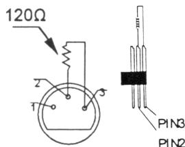
Ein DMX-Abschlusswiderstand ist empfehlenswert für Installationen, bei denen das DMX-Kabel lang ist oder in einer Umgebung mit vielem elektrischem Rauschen (z.B. Discos). Der Abschlusswiderstand verhindert Störung des digitalen Steuersignals durch elektrisches Rauschen. Der DMX-Abschlusswiderstand ist nur eine XLR-Buchse mit einem 120Ω Widerstand zwischen 2 und 3, die den XLR-Ausgang des letzten Geräts in der Kette angeschlossen wird. Siehe Abbildung links.
