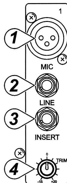
**REMARQUE :** Ne connecter que l'entrée MIC ou l'entrée LINE d'un canal. Ne jamais connecter les deux aux deux canaux simultanément.
