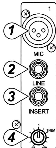
BEMERKUNG: Sie können den MIC-Eingang oder den LINE-Eingang anschließen. Schließen Sie nie die beiden zur gleichen Zeit an denselben Kanal an.
