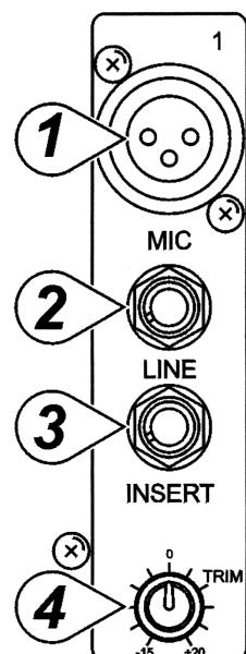
**OPMERKING:** U kunt of de MIC-ingang of de LINE-ingang aansluiten. Sluit nooit beide tegelijkertijd op eenzelfde kanaal.
