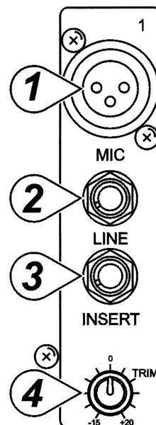
NOTA: Conecte sólo la entrada MIC o la entrada LINE de un canal. Nunca conecte ambas simultáneamente al mismo canal.
