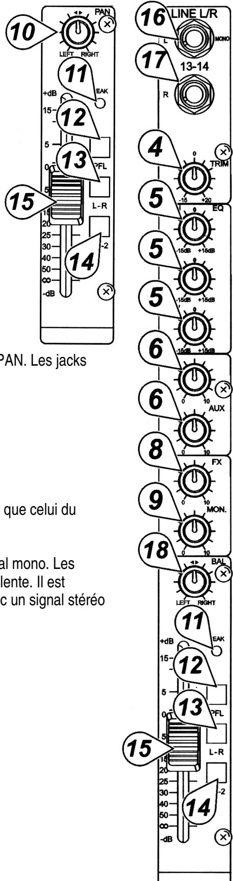
sorties gauche et droite. En configuration stéréo, le régulateur mono PAN (10) est remplacé par le régulateur BALANCE (18).
